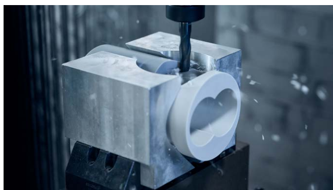
Abb. 1: komplexes Funktionsteil aus POM
